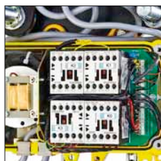
Podwyższone bezpieczeństwo przez sterowanie niskonapięciowe 42V
